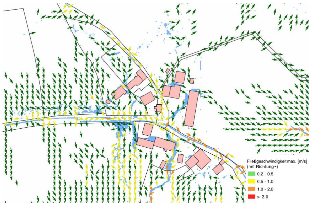
Bild 7: Maximale Fließgeschwindigkeit „Kommunales Starkregenrisikomanagement Bühler EZG“ (Außergewöhnliches Abflussereignis, verschlämmt), 1:2.500
