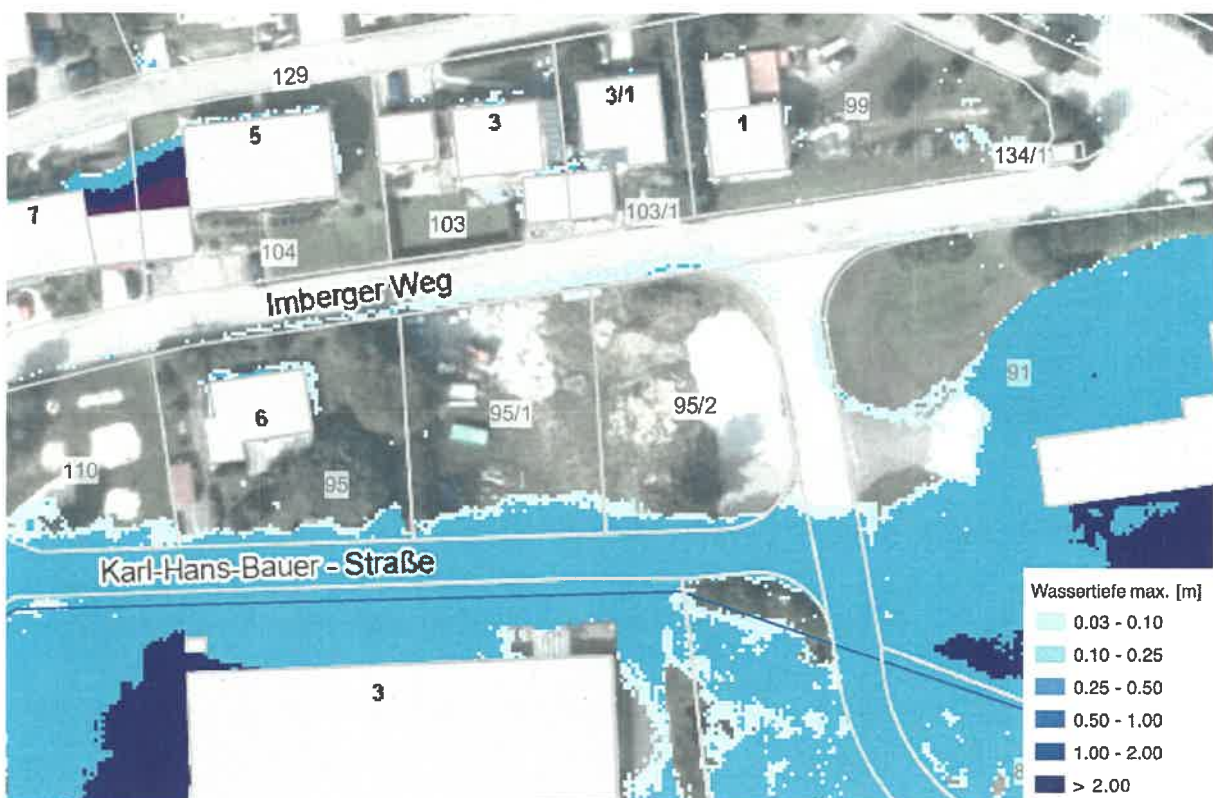
Bild 5: Maximale Überflutungstiefen „Außergewöhnlich verschlammte“ (UDO der LUBW), 1:1.000
