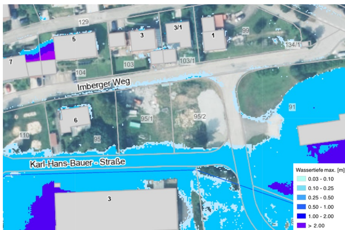
Bild 5: Maximale Überflutungstiefen „Außergewöhnlich verschlammte“ (UDO der LUBW), 1:1.000
